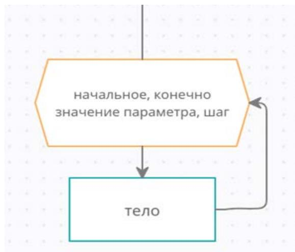
**Рис. 58.** Блок-схема цикла с параметром
